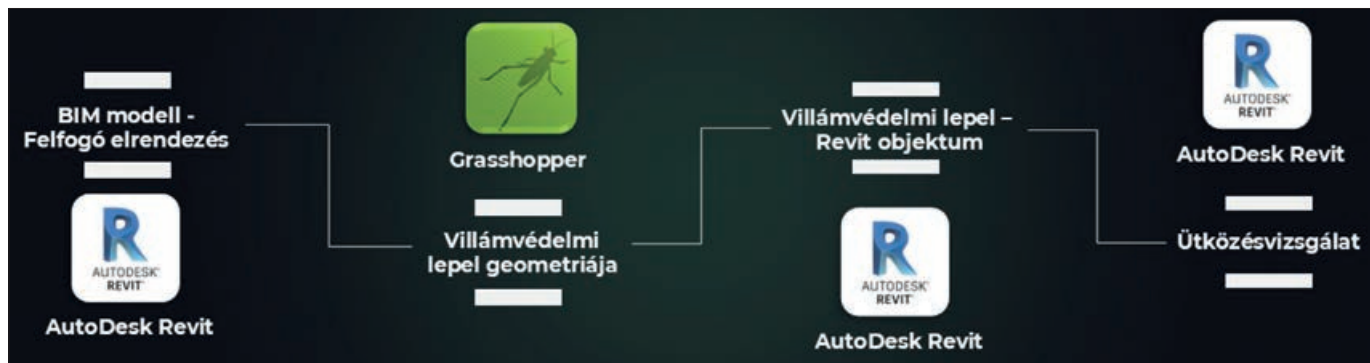
12. ábra: Villámvédelmi védett tér ellenőrzése – Folyamatábra
