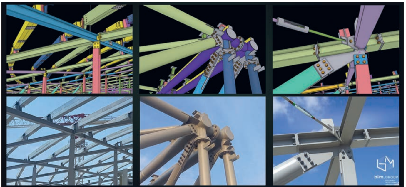
8. ábra: Alba Aréna – Parametrikusan modellezett csomópontok a BIM-modellben és a megvalósult állapotban
