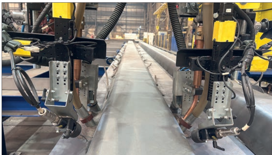
6. kép: Trapézborða hegesztése
