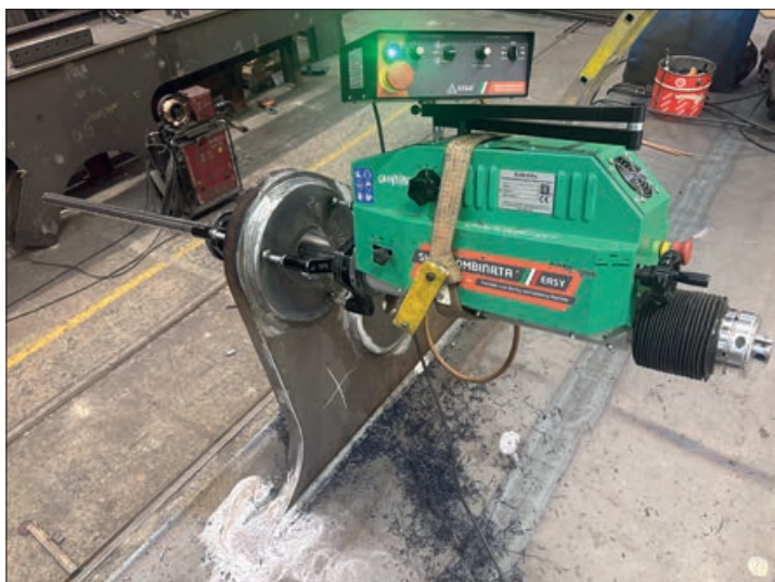
9. kép: Hordozható tengelyfurat-fúró gép
