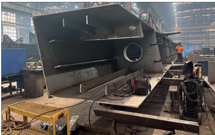
8. kép: Dobozszerkezet összeállítása és hegesztése
