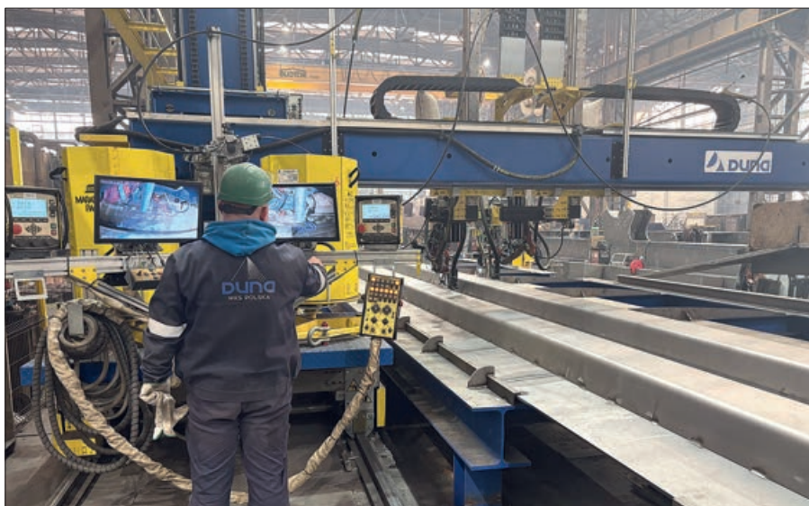
7. kép: Oszlop-gémes hegesztőrendszer kezelőpanel
