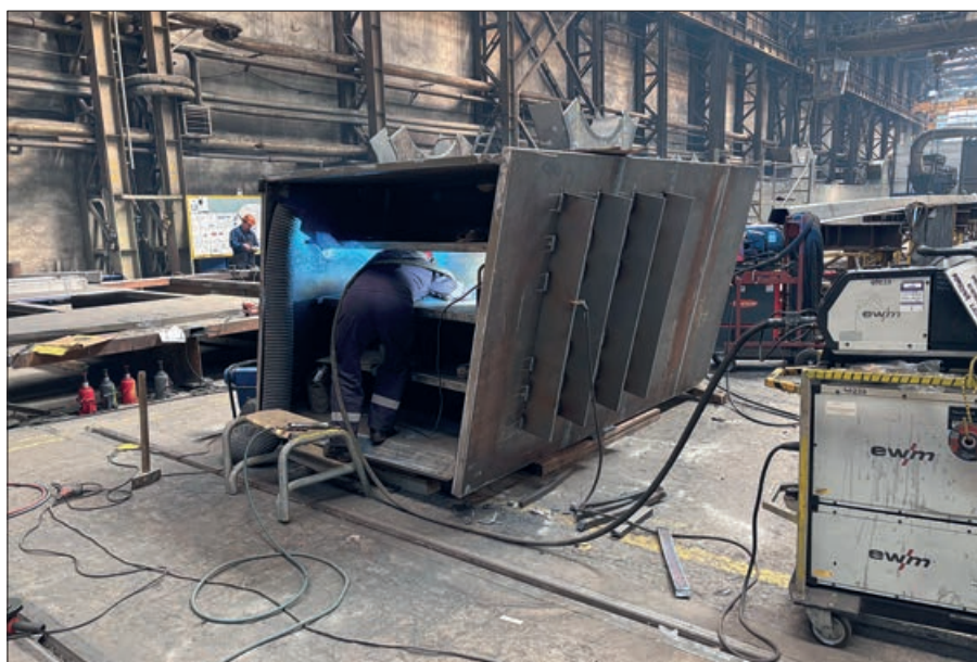
2. kép: Végkereszttartó bordák hegesztése
