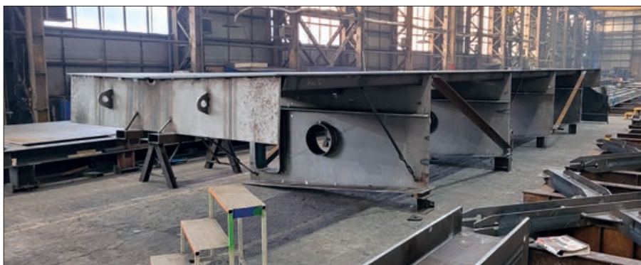
11. kép: Segédszerkezet a pályalemez merevítéséhez
