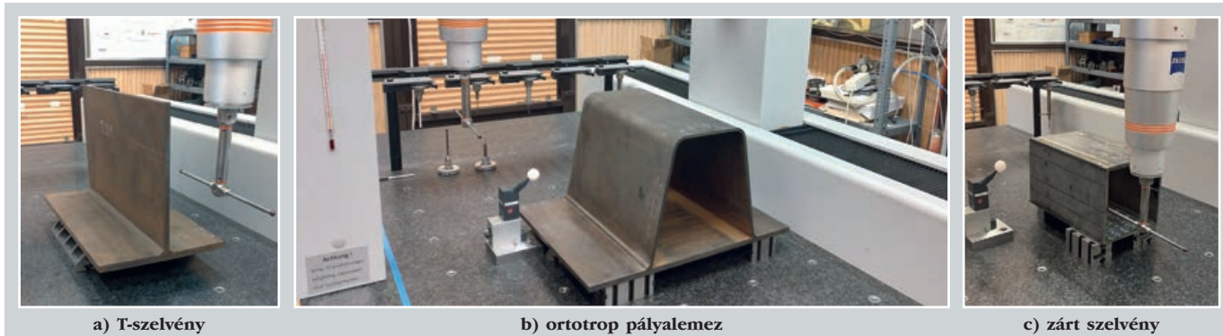
4. ábra: Hegesztett szerkezeti részletek CMM mérései Zeiss UMC 850 gépen [17–19]
