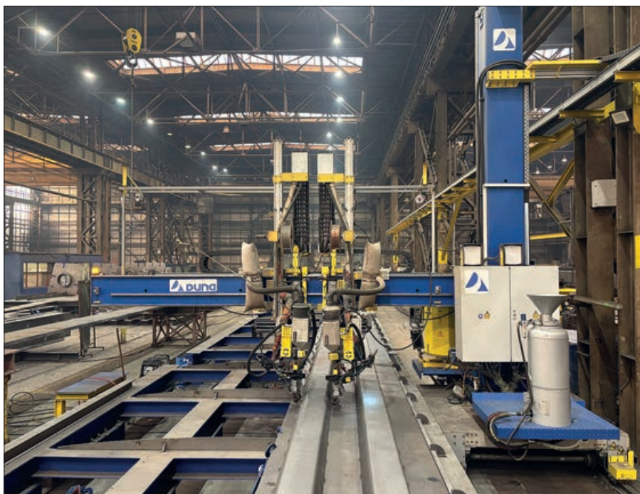
5. kép: Oszlop-gémes (column boom) hegesztőrendszer
