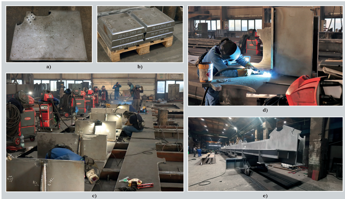
9. ábra: a)–b) vastag lemezes alkatrészek; c)–d) a főtartó alsó ív hegesztése; e) a kész alsó ív szerkezete a korrózióvédelem előtt
