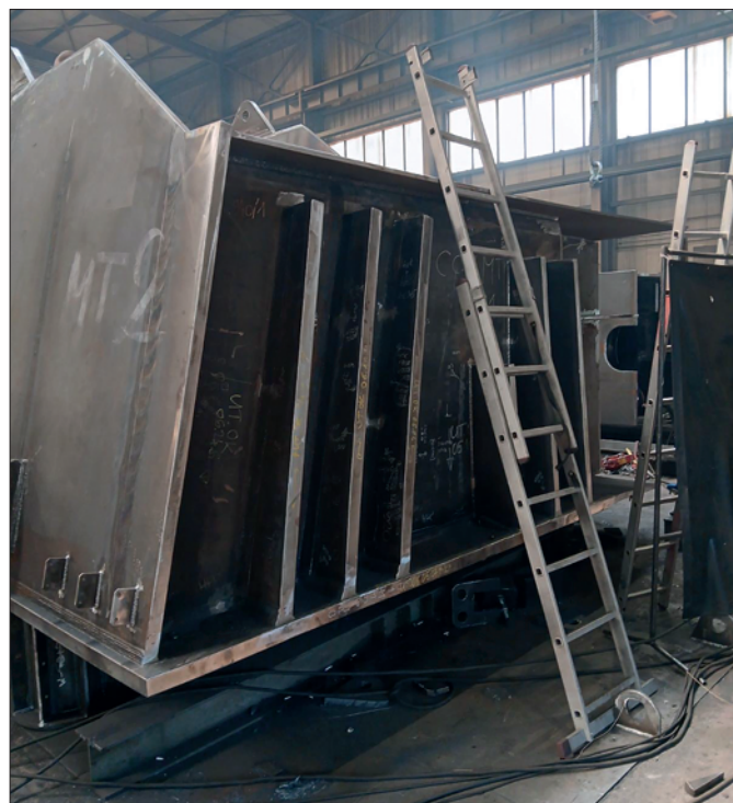
12. ábra: Végkeresztartó záróbordái hegesztés után
