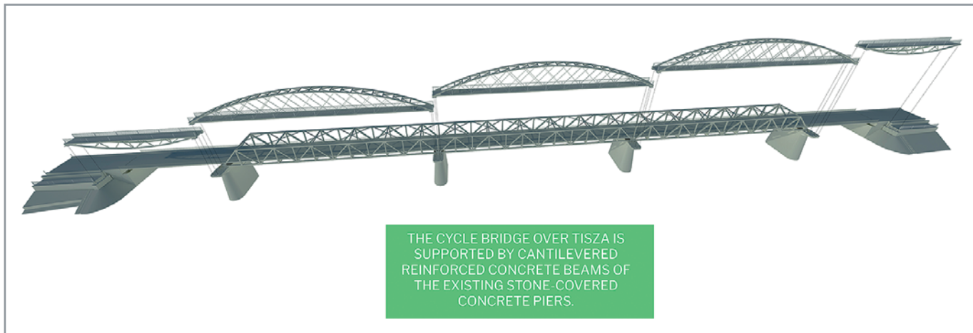
33. ábra: A Poroszlói kerékpáros Tisza-híd a meglévő közúti híd pilléreire támaszkodik
