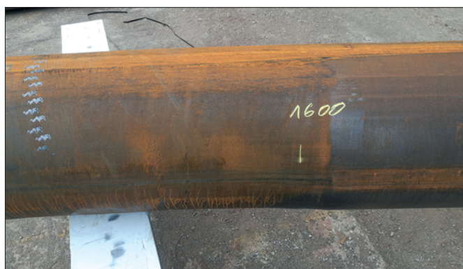
4. ábra: Hajlított cső egyenes (kör) és íves (ovális) szakaszának átmenete (Eger-patak)
