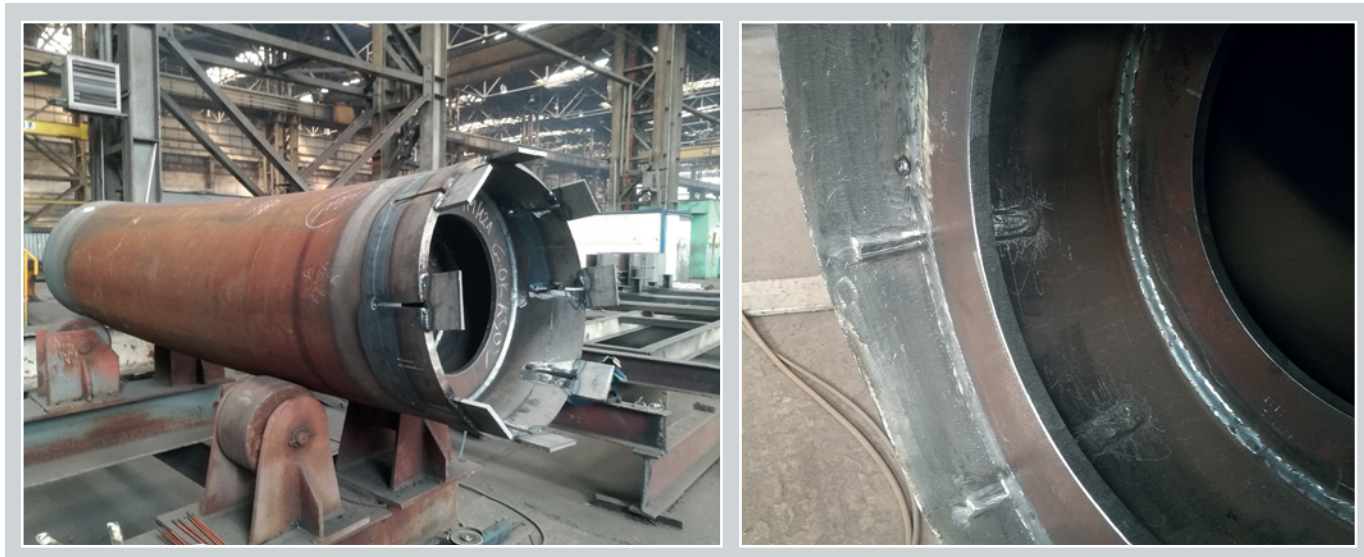
3. ábra: Dimenzióeltérés korrigálása koronás feltágítással (Eger-patak)
