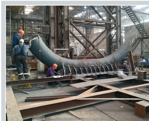
9. ábra: Csőtartó és támasz csatlakozása (Glogoczóv)
