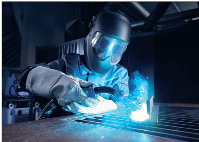
3. kép: Kézi hegesztőpisztolyba integrált füstelszívás
