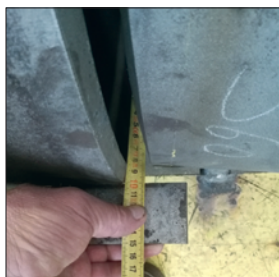
1. ábra: NA610 csövek közel falvastagságot elérő dimenzióeltérése
