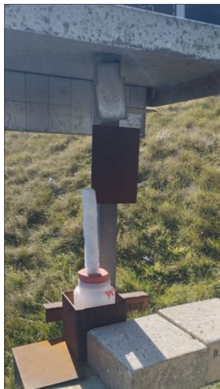
22. kép: → Mérőpont acél próbatestekkel és beton próbakockákkal
