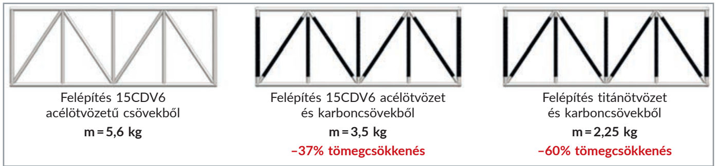
2. ábra: Egyszerű, hegesztett térbeli térrács tömegcsökkentésének lehetősége hibrid társítások alkalmazásával (saját ábra)
