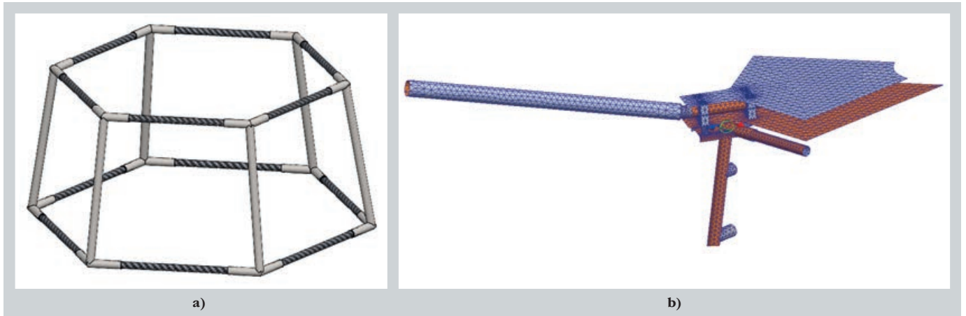
3. ábra: a) Könnyűszerkezetű, hatrotoros UAV tartószerkezeti felépítése, b) végelelemes modell részlete (saját ábrák)
