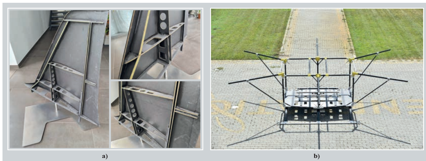
1. ábra: a) Szálerősítéses kompozit kialakítású UAV szárny belső szerkezetének részlete, b) UAV teherhordó drón vázszerkezete hibrid kötés technológiával (saját fotók)
