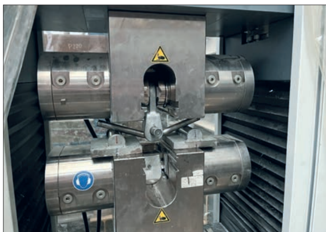
10. ábra: Titán–titán hegesztett tompakötésű minta hárompontos hajlítóvizsgálata (saját fotó)
