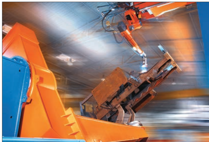
1. ábra: Forgatókészülék – munkadarab-szinkronizáció
