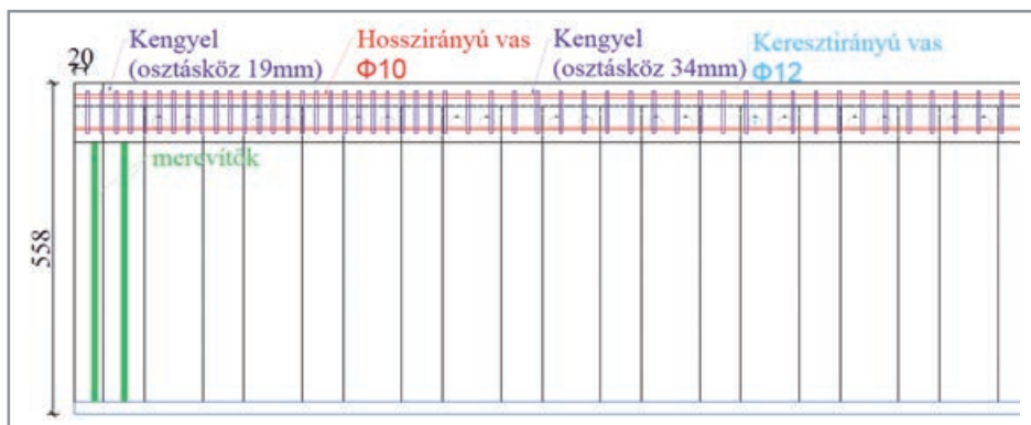
6. ábra: Próbatest oldalnézete (részlet)
