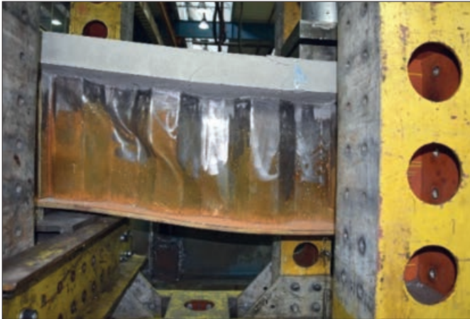
9. ábra: B1/1 próbatest nyírási tönkremenetele
