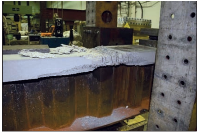
11. ábra: B3 hajlítási tönkremenetele
